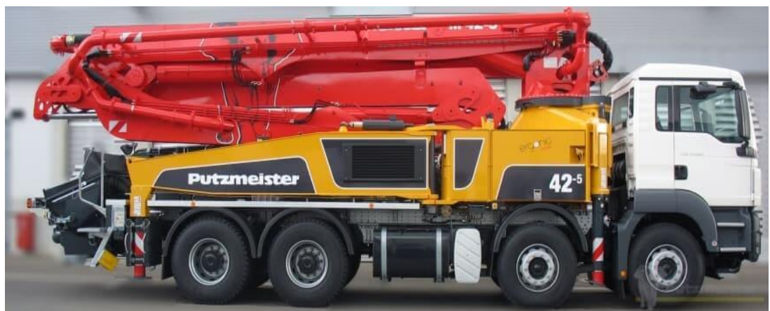
Сурет Б.5- Автобетононасос М 42-5
